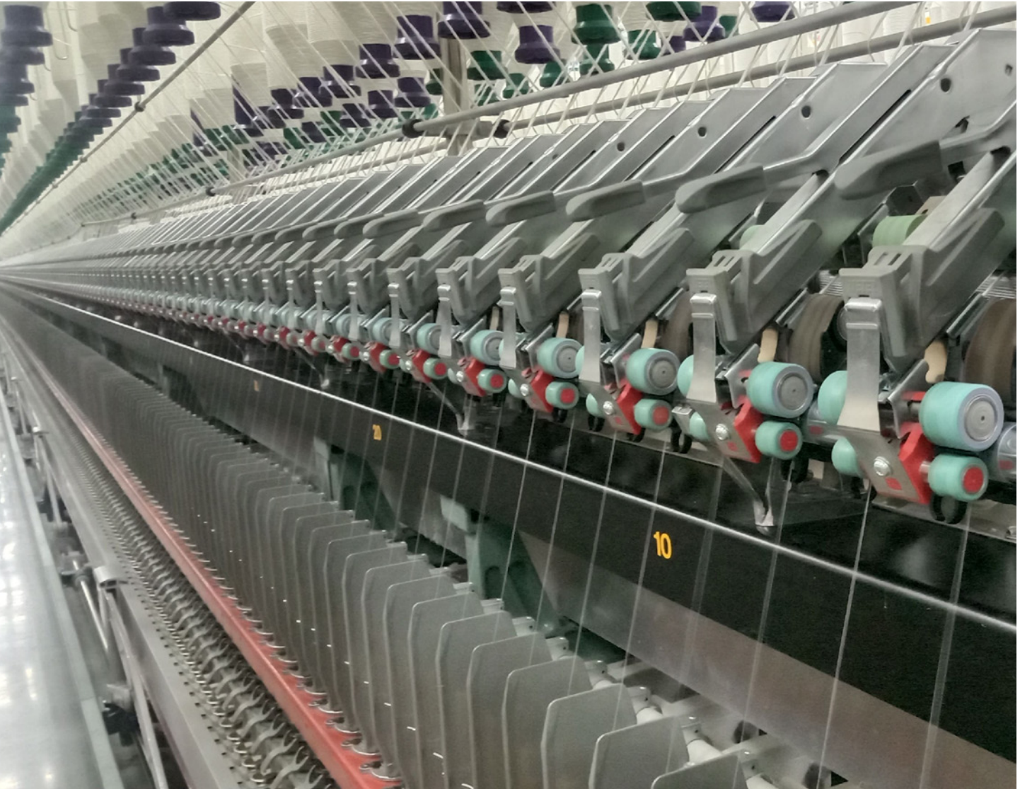
Şek. 1: SuesSEN EliTe ile donatılan 45.000 ring iği ve en yeni mekanik kompaktlama sistemi COMPACTeasyl üstün sonuçlar verir.
